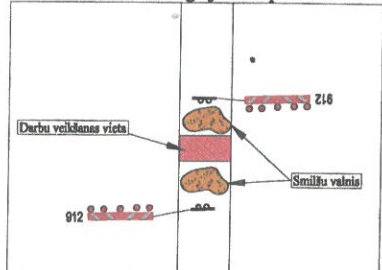
Būvdarbu vietas lokālais aprīkojums satiksmes slēgtajā ielas posmā.
